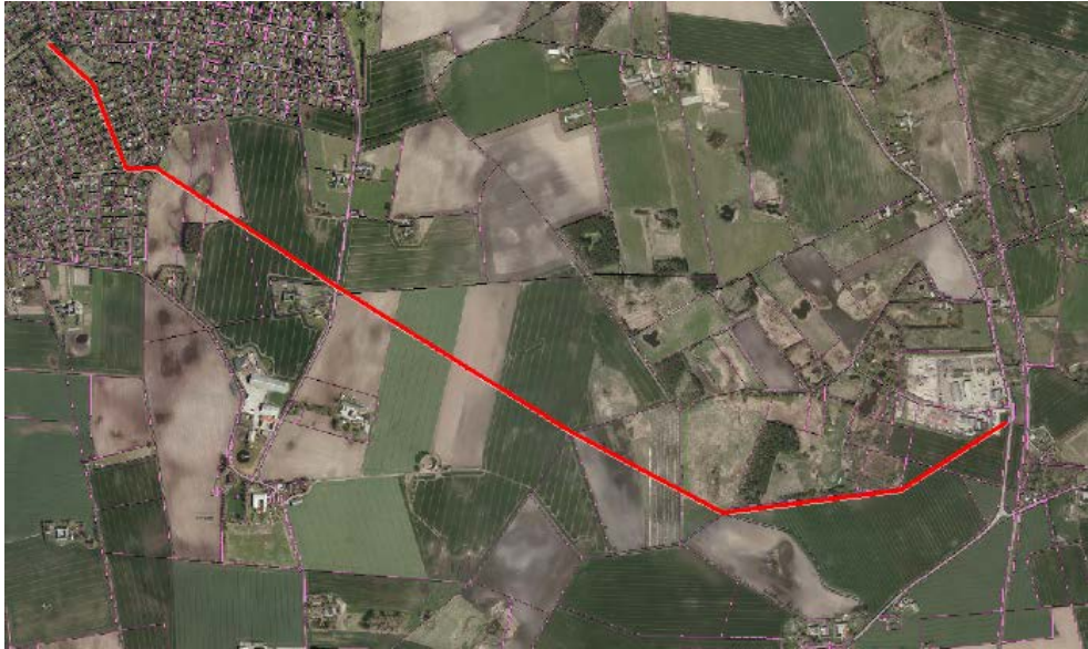
Figur 2. Placering af afskærende ledning fra Smidstrup Renseanlæg til spildevandsledningen fra Pårup til Gilleleje Renseanlæg.
